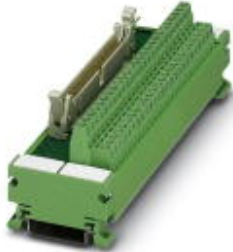
VARIOFACE-Modul, mit Schraubanschluss und Flachbandkabel-Steckverbinder, zur Montage auf NS 35/7,5, Polzahl 34
