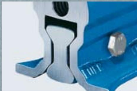
Die geschützte Präzisionsspindellagerung liegt innerhalb der gesenkgeschmiedeten Vorderbacke des Schraubstocks und ist so optimal gegen Beschädigung und Verschmutzung geschützt. Ein Plus, das Ihnen in dieser
