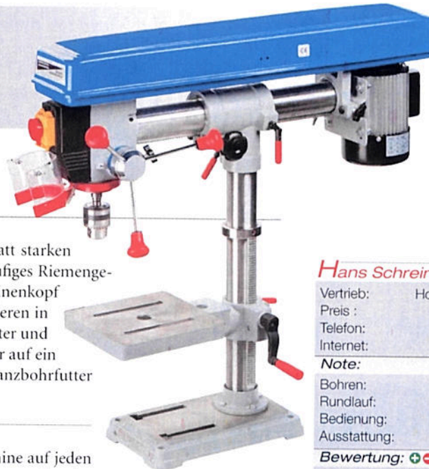
Der in Ausladung und Neigung verstellbare Maschinenkopf erweitert den Einsatzbereich der Maschine deutlich
