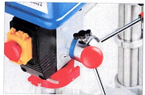
Eine mechanische Tiefeneinstellung erfolgt entweder per Gewindestange mit mm-Skala oder per Anschlagrad direkt am Dreiarm für die Spindelbedienung
