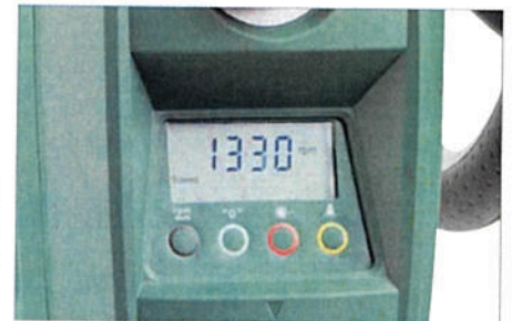
Neben der Spindeldrehzahl lässt sich über das Display und die darunter liegenden Taster auch die Bohrtiefe programmieren
