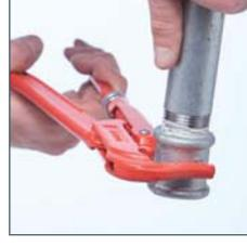
Teile verschrauben und die Verbindung mittels einer Rohrzanze festziehen. Gegebenenfalls nachjustieren.
