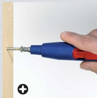
Anziehen einer Schraube mit Kreuzschlitz-Bit PH2 (Bestell-Nr. 00 11 07 + 00 11 08)
