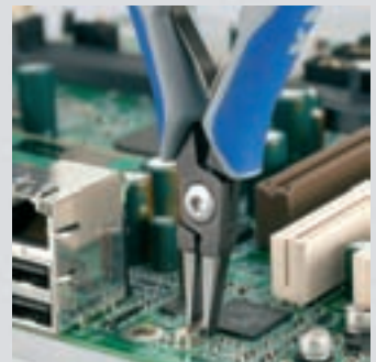
34 12 130: Fixieren von Bauelementen aus vertikaler Richtung
