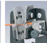
Formschlüssiges Abisolieren durch präzise Messerprofile
