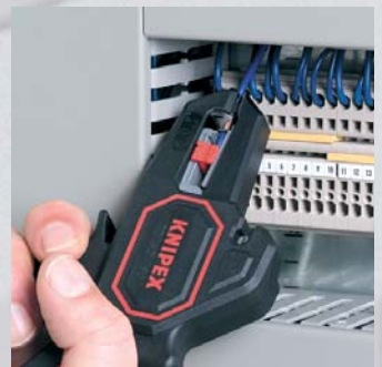
Abisolieren unter beengten Platzverhältnissen
