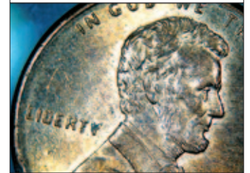
Auflicht Stufe 3: Die unteren beiden LEDs beleuchten fein strukturierte Objekte flach und steigern so den Kontrast.
