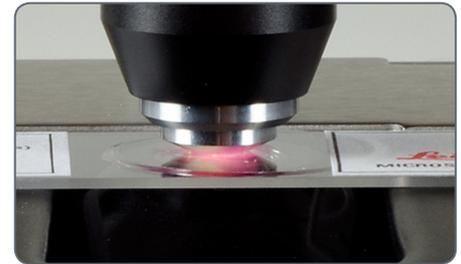
6. Halten Sie den Rändelring am Objektivrevolver und schwingen Sie das Objektiv hin und her, um Luftblasen zu beseitigen. Bringen Sie dann das Ölobjektiv in die endgültige Position, sodass sich der Öltropfen zwischen der vorderen Linse des Objektivs und dem Objektträger befindet.
