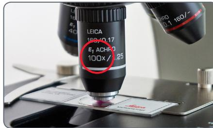
5. Fahren Sie den Objektstisch mithilfe des Grobeinstellknopfes langsam nach oben, bis der Öltropfen auf dem Objektträger gerade mit der Linse des Ölimmersionsobjektivs in Berührung kommt.
