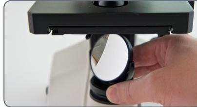
3. Blicken Sie durch die Okulare und richten Sie den Spiegel so aus, dass er eine maximale Wirkung erzielt.
