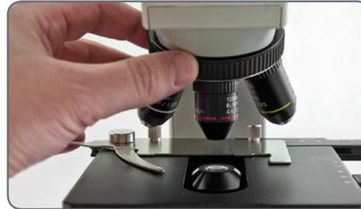
2. Drehen Sie die Kondensor-Blende unter dem Objektstisch so, dass der angezeigte Wert mit dem gewählten Objektiv übereinstimmt.
