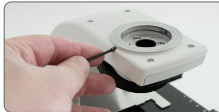
2. Setzen Sie den Schwalbenschwanz des Binokulartubus in die Stativhalterung ein.
