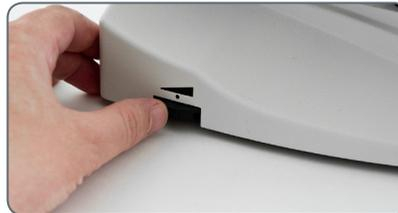
3. Schalten Sie das Mikroskop mit dem Kippschalter auf der Rückseite des Stativs ein.
