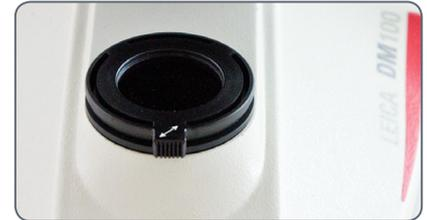
5. Richten Sie den Polarisator durch Drehen aus. Die Pfeile zeigen die aktuelle Ausrichtung.
