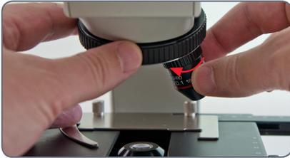
2. Drehen Sie den Objektivrevolver um eine Einheit im Uhrzeigersinn.
