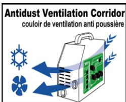
Der spezielle Belüftungskorridor verbessert die Kühlung und vermeidet die Verschmutzung der Elektronik.
