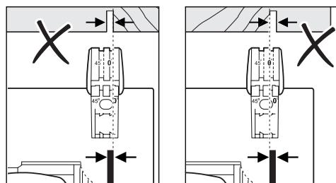
Para um corte exacto, deverá colocar a lâmina de corte sobre a peça, como indicado na figura. Executar, de preferência, um corte de ensaio.
