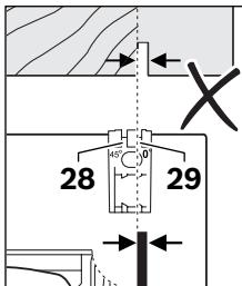
Για να τη διεξαγωγή μιας ακριβούς κοπής οδηγήστε το δισκοπρίονο στο υπό κατεργασία τεμάχιο όπως φαίνεται στην εικόνα. Καλό θα ήταν όμως, να διεξάγετε προηγουμένως μια δοκιμαστική κοπή.
