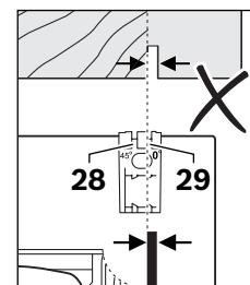
Para obtener un pieza con las medidas correctas, alinee la sierra respecto al trazo según se muestra en la figura. Se recomienda realizar un corte de prueba.
