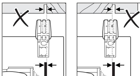
For en målnøyaktig skjæring setter du sirkelsagen på arbeidsstykket som vist på bildet. Utfør helst en prøveskjæring.
