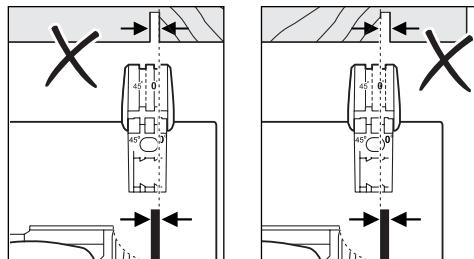
Afin d'obtenir une coupe de grande précision dimensionnelle, positionner la scie circulaire conformément aux indications sur la figure sur la pièce à travailler. Le mieux est d'effectuer une coupe d'essai.
