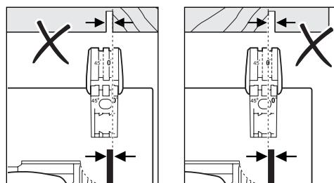
Für einen maßgenauen Schnitt setzen Sie die Kreissäge wie im Bild gezeigt an das Werkstück. Führen Sie am besten einen Probeschnitt durch.
