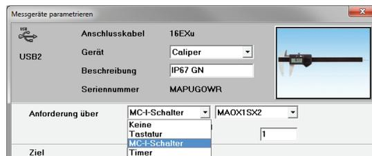
Bei Anforderung über „Timer“, lässt sich eine zyklische Messwertanforderung über eine Zeitsteuerung einstellen. Dabei kann man einen Zyklus in Stunden, Minuten und Sekunden eingeben. Der Timer-Ablauf kann dann im Konfigurationsfenster mit einem Klick auf das Timer-Symbol gestartet und gestoppt werden.
