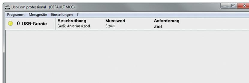
In diesem Konfigurationsfenster werden die angeschlossenen Messgeräte angezeigt und konfiguriert. Nach der Erstinstallation wird i.d.R. eine freie serielle COM-Schnittstelle angezeigt, sofern der verwendete Rechner über eine solche verfügt.
