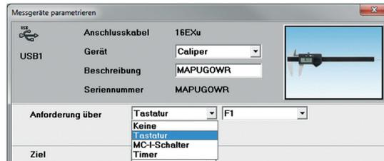
Bei Anforderung über *MC-I Schalter* (Fußschalter) kann man zusätzlich zwischen „bei jeder Messung“ (d.h. bei jedem Betätigen des Schalters wird ein Messwert übertragen) oder „bei Messung Nr.“ (d.h. der Messwert wird nach dem x-ten Betätigen des Schalters im Messzyklus übertragen) wählen. Wie Sie einen Messzyklus definieren finden Sie unter 5.1 MC-I Schalter.
