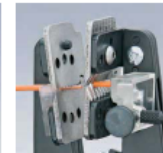
Formschlüssiges Abisolieren durch präzise Messerprofile
