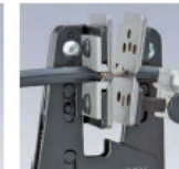
Automatisches Abziehen der Isolation
