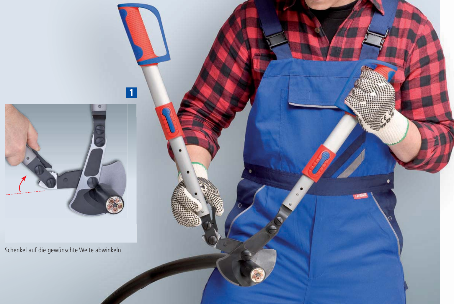
Nach dem ersten Teilschnitt die Schenkel per Ratschenprinzip öffnen
