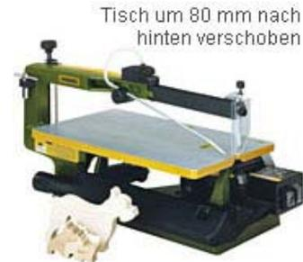
Innovative Problemlösung (patentiert): Zum Erleichtern des Sägeblattwechsels kann man den waagrecht gestellten Tisch entriegeln und um 80 mm nach hinten verschieben. Für freie Sicht vor allem auf den unteren Sägearm beim Einklinken des Kulissensteines oder eines Sägeblattes mit Querstift.
