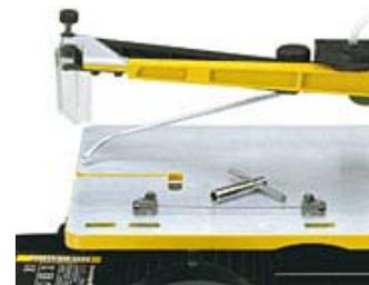
Patentierte Kulissensteine mit hoher Spannkraft sorgen für genau fluchtende Sägeblätter. Ausnehmungen in der Tischoberfläche fixieren Position und Distanz der Kulissensteine und erleichtern die Montage des Sägeblattes.
