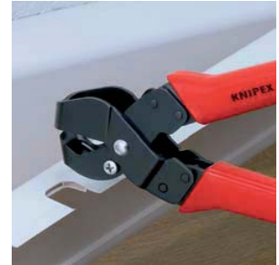
Spezialzangen für besondere Anwendungen, z. B. zum Ausklinken oder Ausstanzen unterschiedlicher Materialien (Blechknabber, Fliesenlochzange usw.)
