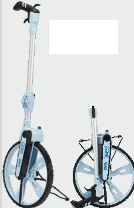
Großes Rad für Innen- und Außenmessungen. Raddurchmesser 320,1 mm. Komfortables Abrollen auch im Gelände. Packmaß 53 cm. Kleinste Maßeinheit 10 cm. Messbereich bis circa 10 km. Revolvergriff mit Stoptaste und Resettaste. Lieferung mit Tasche.
