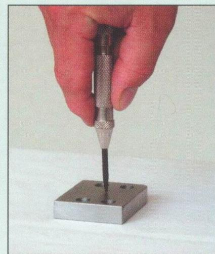
Körnerspitze auf die zu markierende Stelle aufsetzen. Durch Druck auf den Körner die eingestellte Schlagkraft überwinden und somit den Schlag auslösen.
