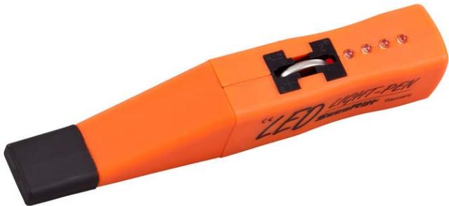
Bremsflüssigkeitstester Check PEN verbesserte Software und jetzt vollautomatisch Zu Sicherheit wird empfohlen, regelmäßig die Bremsflüssigkeit des Fahrzeuges zu prüfen. Der Bremsflüssigkeitstester ermöglicht auf einfachste Weise, den Feuchtigkeitsgehalt der Bremsflüssigkeit festzustellen.
