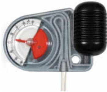
Der Frostschutzprüfer Microtemp ist ein robustes Messgerät, das bei allen Kühlwassertemperaturen sehr genau anzeigt und sich direkt ablesen lässt. Die besondere Konstruktion bietet entscheidende Vorteile für die Praxis.
