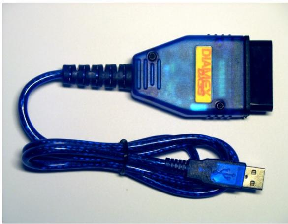
Das DIAMEX-DX35-Interface dient zum Auslesen von Kfz-Daten, die über den OBD-II-Diagnoseport bereitgestellt werden. Es werden geliefert: das Diagnose-Interface und eine Software-CD „moDiag-express“. Das Interface übersetzt die Signale des OBD-II Diagnoseports in für den Computer verständliche serielle Daten.
