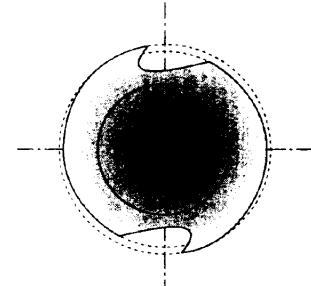
2. Radial angepaßter CBN-Hinterschliff
