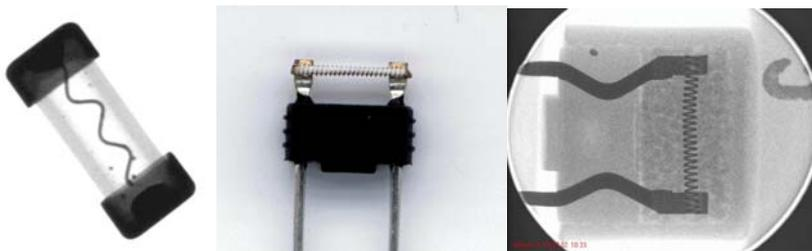
Prioritär wird die Sicherungscharakteristik innerhalb einer Bauform durch den Schmelzleiter bestimmt, d.h. durch das Kerndrahtmaterial, evtl. darauf aufgebrachte galvanische Schichten und die Art und Weise, wie der Schmelzleiter im Sicherungsgehäuse angebracht wird: entweder als glatt gezogener Draht, gewickelt auf einem Trägermaterial oder profiliert mit einer Wellenform. Der Nennstrom wird maßgeblich durch den Durchmesser des Schmelzleiters bestimmt.
