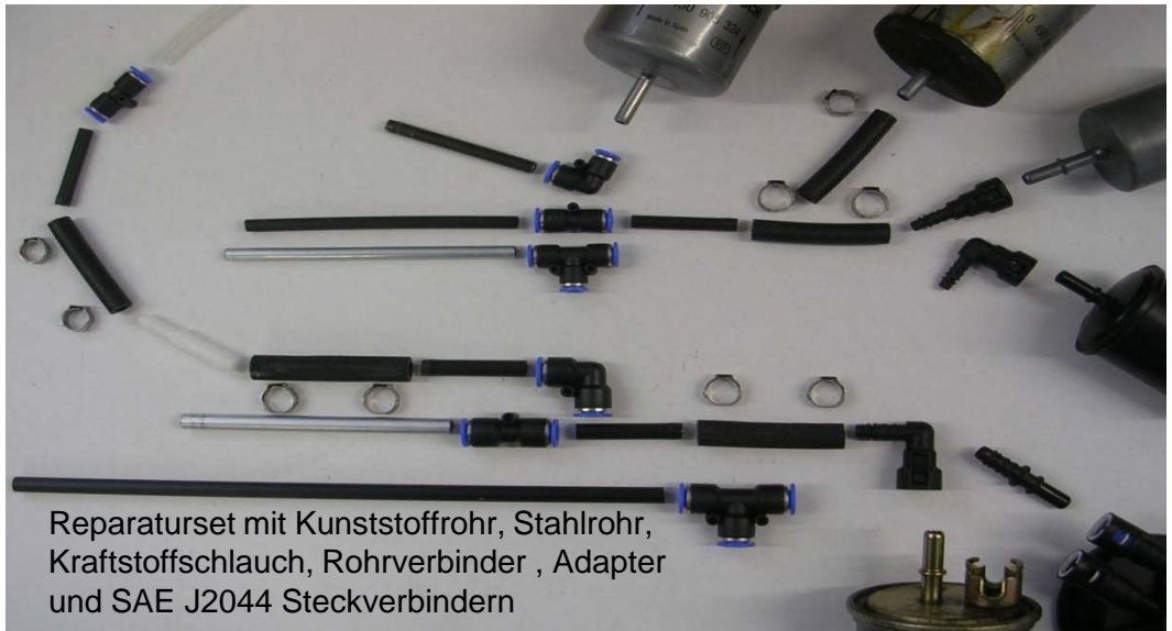
Stecker brechen bei der Demontage für den Filterwechsel
