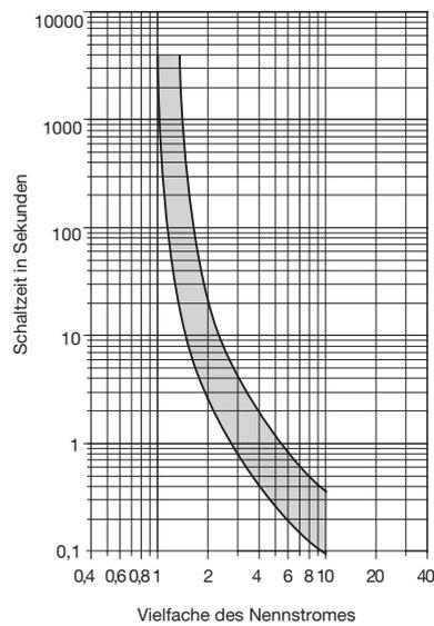
Die Zeit/Strom-Kennlinien sind abhängig von den Umgebungstemperaturen. Um eine vorzeitige oder späte Abschaltung zu vermeiden, muss der Schutzschalterennennstrom mit einem Temperaturfaktor multipliziert werden (siehe auch Kapitel 9 – Technische Informationen).
