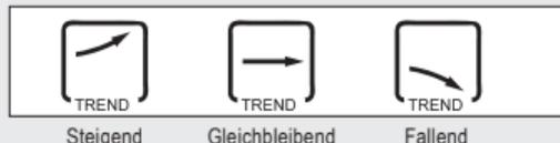
Anzeige der Luftdrucktendenz
