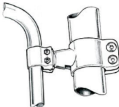
**Zum Abnehmen des Schlosses** drehen Sie den Schloßhalter um 90° und ziehen Sie das Schloß aus der Halterung.
