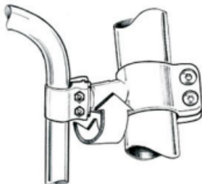
**Drücken Sie den Schloßhalter gegen die Rahmenhalterung und drehen Sie diesen dann um 90°**, sodass das Schloss sicher und stabil am Fahrradrahmen befestigt ist.
