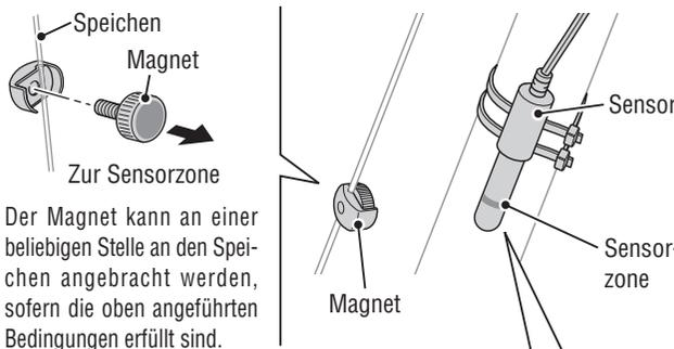
\* Der Magnet kann an einer beliebigen Stelle an den Speichen angebracht werden, sofern die oben angeführten Bedingungen erfüllt sind.
