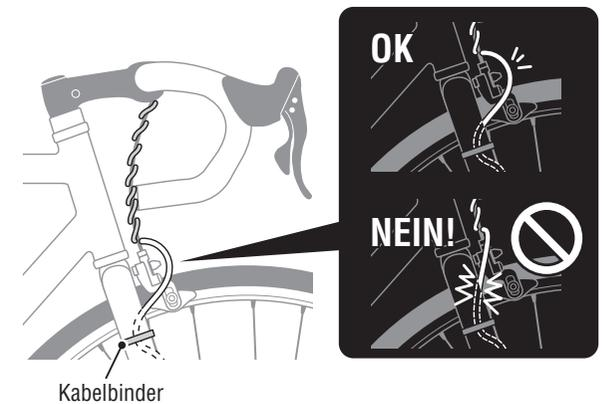
**Achtung:** Verlegen Sie das Kabel so, dass bei Benutzung des Lenkers keine Probleme auftreten.
