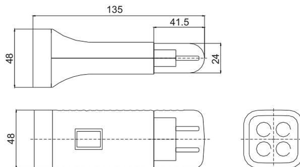
Bild 3: Abmessungen Multi LED, Typ 4132...
