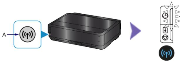
2. Stellen Sie sicher, dass die (blaue) Wi-Fi-Anzeige schnell blinkt und die POWER-Anzeige wie in der Abbildung oben gezeigt leuchtet. Drücken und halten Sie dann die Taste am Zugriffspunkt innerhalb von 2 Minuten.
