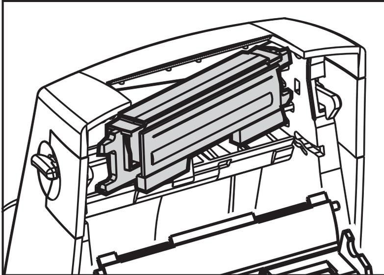
3. Lösen Sie mit einem Kreuzschraubendreher Nr. 1 die Schraube, durch die das Erdungskabel befestigt ist. Ziehen Sie das Kabel aus der Halterung.
