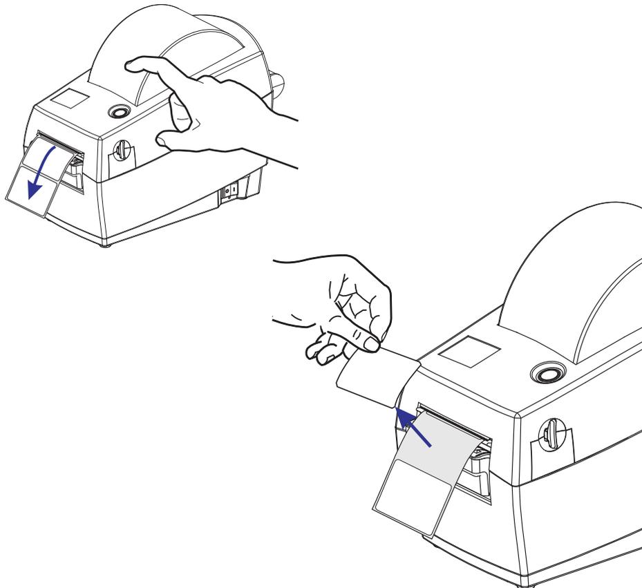
2. Schlagen Sie das Trägermaterial über den Drucker zurück, und öffnen Sie die Klappe des Etikettenspenders.
