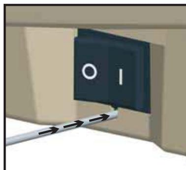
**Vorsicht** • Drücken Sie die Reset-Taste **NICHT** während der Defragmentierung (Statusanzeige blinkt rot - gelb - grün). Dadurch könnte der Drucker beschädigt werden.
