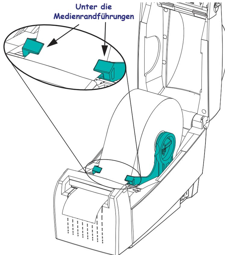
6. Schließen Sie den Drucker. Zum Absenken der oberen Abdeckung müssen Sie zuerst die Einrastknöpfe in die Mitte des Druckers drücken. Drücken Sie dann die obere Abdeckung vorsichtig auf das Druckergehäuse. Drücken Sie beide Seiten, bis die Abdeckung mit einem Klickgeräusch einrastet.
