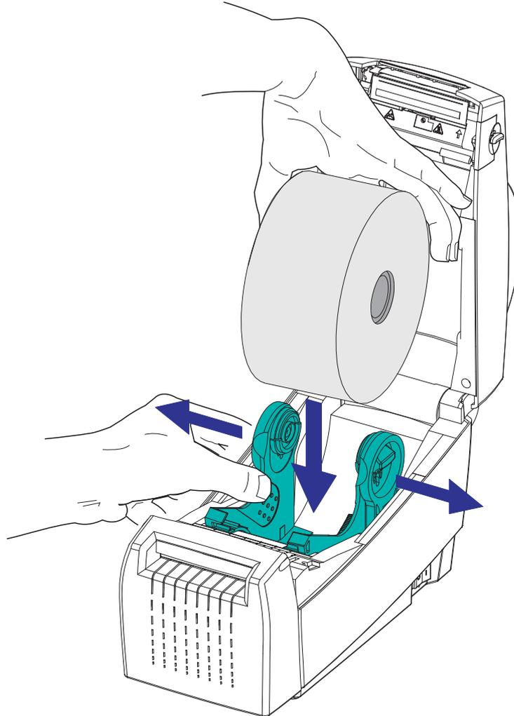
4. Ziehen Sie das Medium so weit durch die Schneidevorrichtung hindurch, dass es an der Vorderseite des Druckers herausragt. Überprüfen Sie, ob sich die Rolle frei drehen kann. Die Rolle darf nicht im Medienfach aufliegen. Die zu bedruckende Seite des Mediums muss nach oben zeigen.
