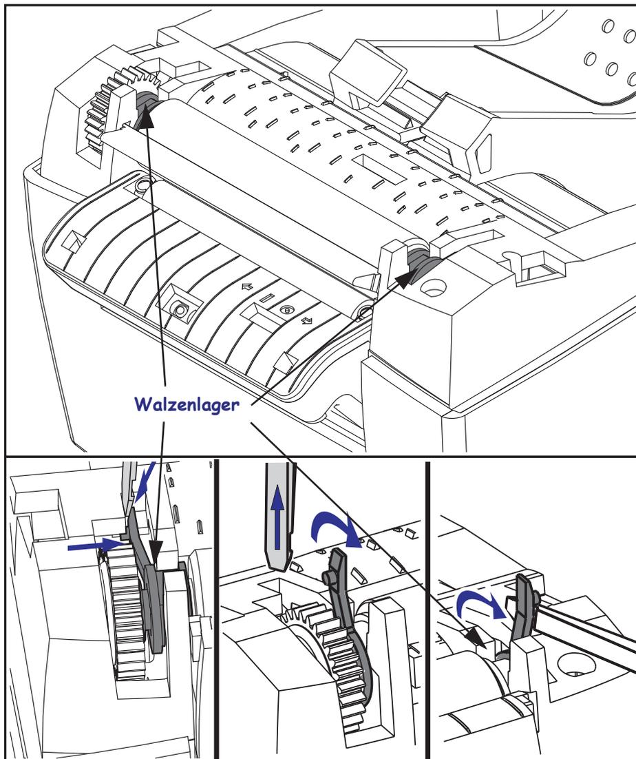
3. Heben Sie die Auflagerwalze aus dem unteren Druckerrahmen heraus.
