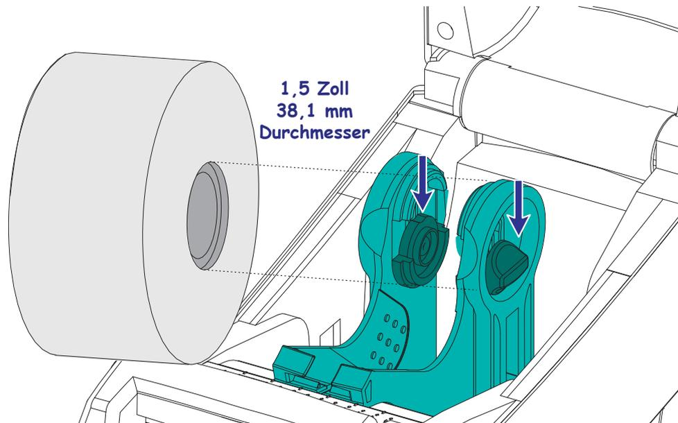
3. Öffnen Sie die Medienrollenhalterungen. Ziehen Sie die Medienrandführungen mit der Hand auseinander, setzen Sie die Medienrolle auf die Rollenhalterung, und lassen Sie die Führungen wieder los. Richten Sie die Medienrolle so aus, dass die zu bedruckende Seite beim Laufen über die Auflagewalze (Antriebswalze) nach oben zeigt.
