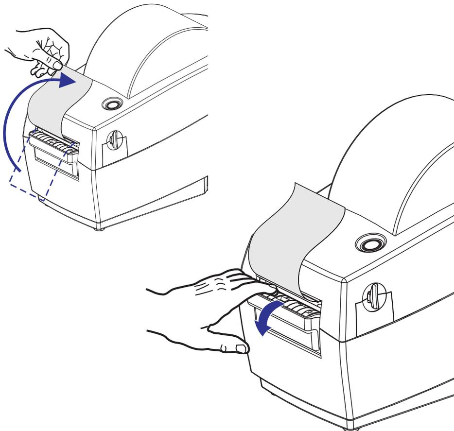
3. Ziehen Sie das Trägermaterial durch den Schlitz zwischen der Klappe des Etikettenspenders und dem Drucker nach unten.
