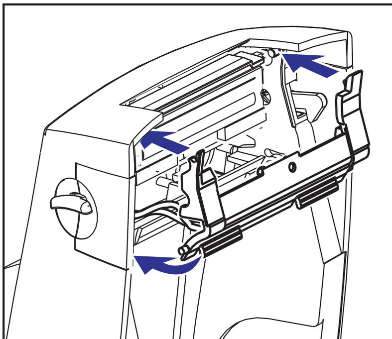
5. Überprüfen Sie, ob der Druckkopf mit etwas Druck nach oben und unten bewegt werden kann und dann an der entsprechenden Position bleibt.
