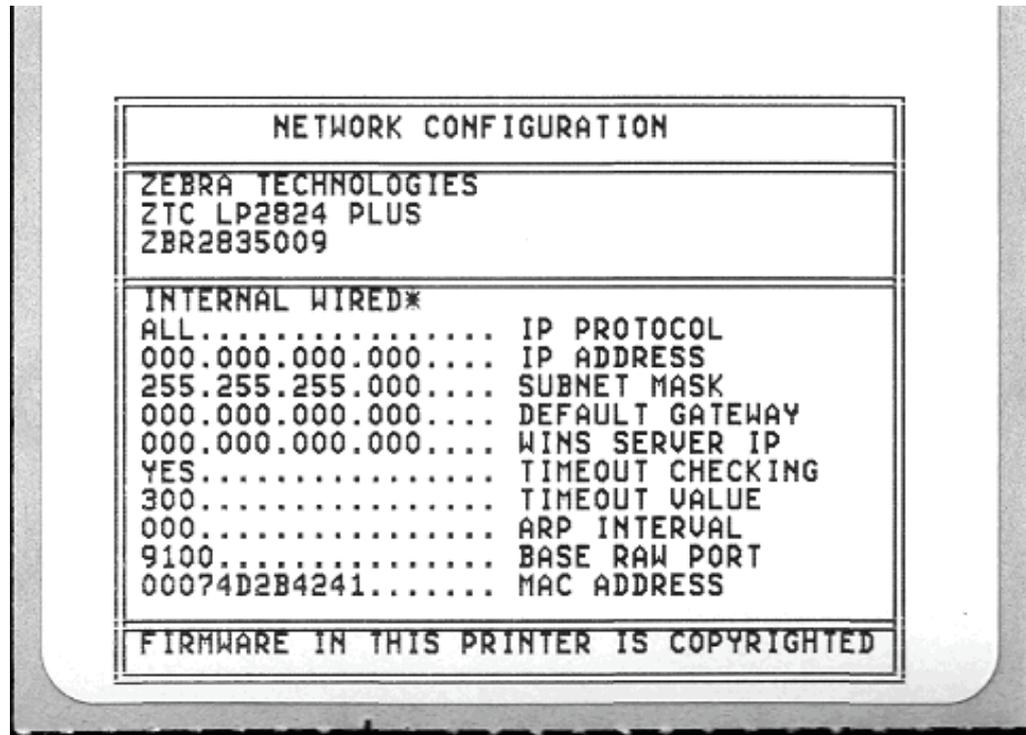
In der unteren Hälfte des Konfigurationsstatusetiketts sind in der Regel einige Netzwerkeinstellungen des Druckers (z. B. die IP-Adresse) aufgeführt.
