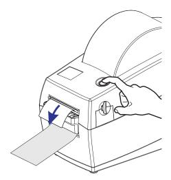
**6.** Beim Drucken zieht der Drucker das Trägermaterial ab und gibt ein einzelnes Etikett aus. Wenn das Etikett abgezogen wird, druckt der Drucker das nächste Etikett. Hinweis: Wenn Sie den Sensor für abgelöste Etiketten nicht über die entsprechenden Softwarebefehle aktiviert haben, werden die abgezogenen Etiketten vom Drucker gestapelt und ausgeworfen.
