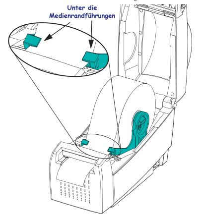
6. Schließen Sie den Drucker. Zum Absenken der oberen Abdeckung müssen Sie zuerst die Einrastknöpfe in die Mitte des Druckers drücken. Drücken Sie dann die obere Abdeckung vorsichtig auf das Druckergehäuse. Drücken Sie beide Seiten, bis die Abdeckung mit einem Klickgeräusch einrastet.
