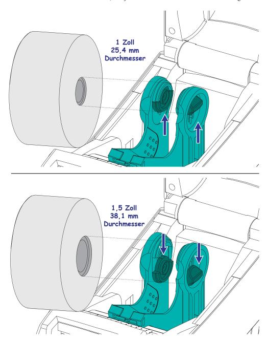
3. Öffnen Sie die Medienrollenhalterungen. Ziehen Sie die Medienrandführungen mit der Hand auseinander, setzen Sie die Medienrolle auf die Rollenhalterung, und lassen Sie die Führungen wieder los. Richten Sie die Medienrolle so aus, dass die zu bedruckende Seite beim Laufen über die Auflagewalze (Antriebswalze) nach oben zeigt.
