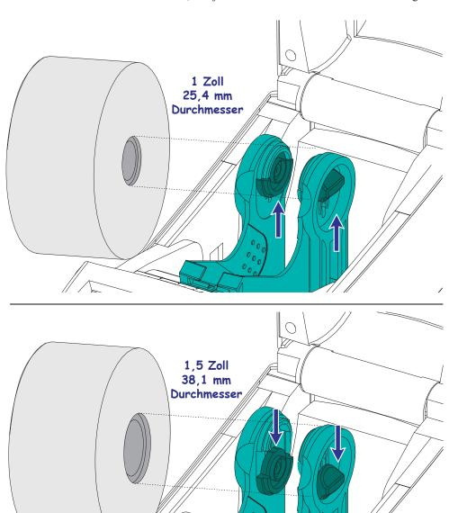
3. Öffnen Sie die Medienrollenhalterungen. Ziehen Sie die Medienrandführungen mit der Hand auseinander, setzen Sie die Medienrolle auf die Rollenhalterung, und lassen Sie die Führungen wieder los. Richten Sie die Medienrolle so aus, dass die zu bedruckende Seite beim Laufen über die Auflagewalze (Antriebswalze) nach oben zeigt.
