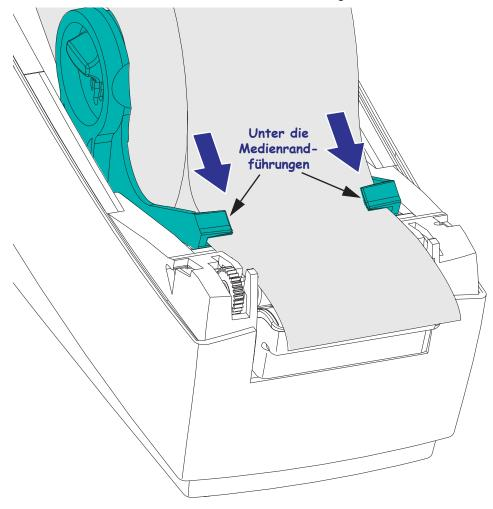
5. Schließen Sie den Drucker. Zum Absenken der oberen Abdeckung müssen Sie zuerst die Einrastknöpfe in die Mitte des Druckers drücken. Drücken Sie dann die obere Abdeckung vorsichtig auf das Druckergehäuse. Drücken Sie beide Seiten, bis die Abdeckung mit einem Klickgeräusch einrastet.
