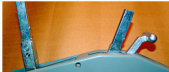
3. Hinteren Hebel auf Mitte, mittleren und Fixierhebel mit einem Ruck hochziehen, beide rasten ein.
