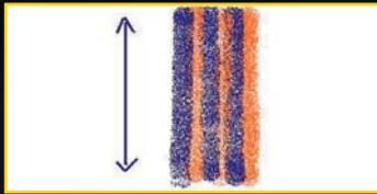
2. Danach überlappenden Bahnen in die entgegengesetzte Richtung ziehen.
