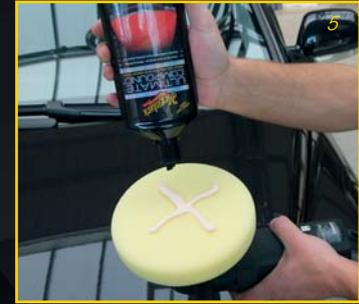
Vor der ersten Benutzung wird der neue Polierschwamm mit Quik Detailer angefeuchtet. Nun wird die Politur X-förmig auf den Polierschwamm aufgetragen. (Bild 4 + 5)
