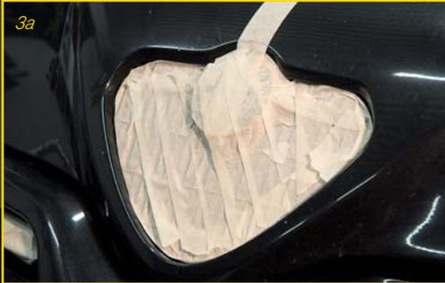
Bevor der Lack mit der Maschine bearbeitet wird, müssen alle nicht lackierten Kunststoffteile, Fenster- und Türummrisse abgeklebt werden. Dies verhindert hässliche Polierreste an diesen Teilen, die nur schwer zu entfernen sind.
