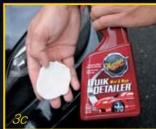
Alle Schmutzpartikel auf der Lackoberfläche und sogar alte Wachsreste werden von der Knete aufgenommen, ohne den Lack zu verkratzen. Die Knete sollte abhängig vom Verschmutzungsgrad neu zusammengefasst und bei zu starker Verschmutzung ausgetauscht werden. (Bild 3a - 3c)
