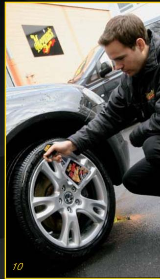
Alternativ kann auch Hot Shine Tire Spray verwendet werden. Dieses Produkt hat einen verstellbaren Sprühkopf und kann direkt auf die Reifenflanken gesprüht werden. Eventuelle Produktüberstände mit einem Applicator Pad entfernen, da sonst beim Fahren Spritzer auf den Lack gelangen können. Sollten ein paar Spritzer auf die Felge geraten sein, einfach mit Quik Detailer und einem Mikrofasertuch entfernen. (Bild 10)
