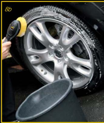
Zu einer Top gepflegten Felge gehört natürlich auch ein glänzender, schwarzer Reifen! Die Reifen mit einem Autoschampoo unter Zuhilfenahme der Meguiar's Tire Brush reinigen. Die Reifenbürste hat weiche Spezialborsten am Rand, dadurch wird ein Verkratzen der Felge verhindert. (Bild 8a + 8b)
