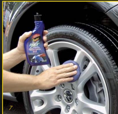
Bei leichten Verkratzungen und stumpfen Stellen auf lackierten oder mit Klarlack versiegelten Felgen kann eine Politur mit Schleifkorn eingesetzt werden, wie z.B. Meguiar's ScratchX 2.0 oder Deep Crystal Paint Cleaner! (Bild 6)
