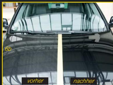
Durch den Einsatz von Deep Crystal Polish Step 2 von Meguiar's bekommt der Lack noch das Quäntchen MEHR an Glanz. Deep Crystal Polish ist eine reine Politur ohne Schleifkorn, die pflegend und Glanz erzeugende Öle enthält und für den typischen „American Wetlook“ sorgt. DC Polish ist keine Versiegelung! (Bild 6a + 6b)
