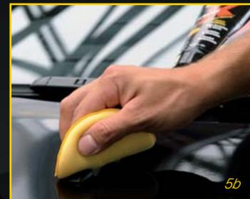
Jetzt ist der Lack soweit vorbereitet, dass entweder noch eine reine Politur ohne Schleifkorn zum Einsatz kommt oder der Lack gleich mit NXT Tech Wax 2.0 versiegelt werden kann. Wichtig ist es, nicht lackierte Kunststoffteile entweder mit Ultimate Protectant – einem Kunststoffpflegeprodukt von Meguiar's – vor dem Versiegeln zu bearbeiten oder diese Teile abzukleben! Die Versiegelung/Wachs hinterlässt sonst auf dem Kunststoff weiße Ränder oder eine farbliche Veränderung. (Bild 5a - 5c)
