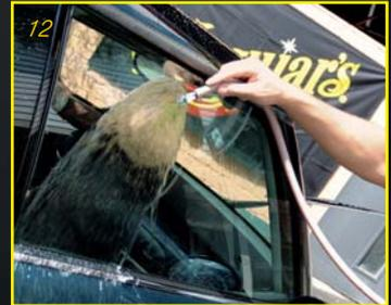
Nach der kompletten Fahrzeugwäsche – bei hohen Außentemperaturen das Fahrzeug stets im Schatten waschen und nicht in der prallen Sonne, da sonst Wasserflecken durch An trocknung der Waschlotion entstehen können – den Wagen mit einem Schlauch ohne Sprühkopf abspülen (Bild 11+12), damit das Wasser großflächig abläuft und keine Wassertropfen entstehen.
