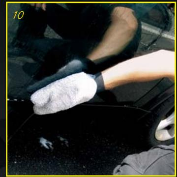
Den Wagen immer von oben anfangend waschen (Bild 9). Das untere Drittel zuletzt mit dem hierfür vorgesehen Waschhandschuh bearbeiten (Bild 10), dadurch wird die Entstehung von Waschkratzern deutlich vermindert. Bitte verwenden Sie keine Naturschwämme, da hier die Gefahr besteht, dass sich Sandkörner oder ähnliche Kratzer verursachende Partikel in der Struktur des Schwammes festsetzen. Diese können, z.B. bei Ausübung von Druck, hässliche Kratzer verursachen.
