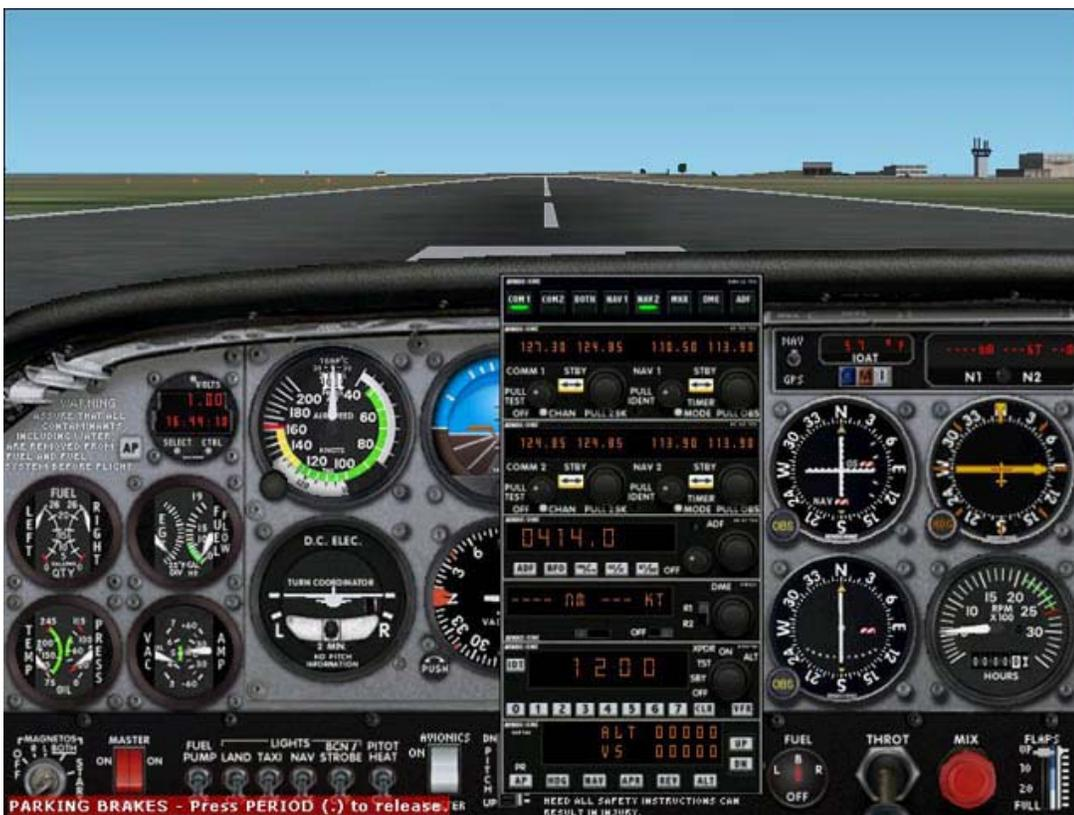
**Anpassung der Einstellungen des Radios Stacks unter Verwendung der Schaltflächen und der Anzeige des X52 iMFD**
