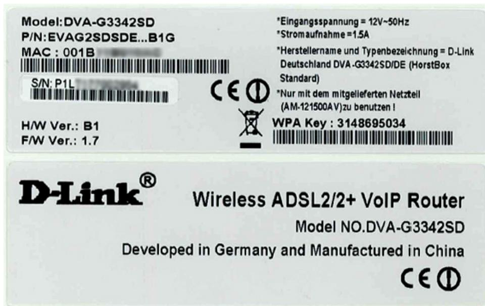
Abbildung 2.4: Netzwerkschlüssel auf der Geräteunterseite
