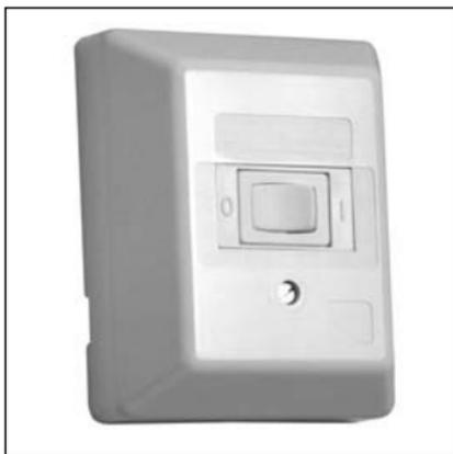
Das **SAR1** schaltet beim Anlegen einer Steuerspannung (z. B. ankommende Rufspannung (AC) einer Telekommunikations-Anschlussleitung) über einen Kontakt die Funktion eines externen Signalgebers (z. B. Klingel, Hupe oder Lampe) mit eigener bzw. separater Stromversorgung ein. Mit einem eingebauten Schalter kann die externe Signalisierung wahlweise ein- bzw. ausgeschaltet werden.
