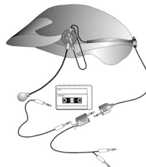
Mikrofon und Ohrhörer, Montage am Fahrradhelm, Sendetaste, Anschluss auch für MP3 Player etc.
