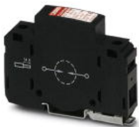
Typ 1 / Class I / B-Ableiter (Blitzstromableiter) mit gekapselter Arc-Chopping-Funkenstrecke, 1-kanalig. Gehäusebreite: 17,5 mm (1TE)
