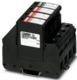
Universeller steckbarer Blitzstromableiter auf Varistorbasis für 3-phasige Stromversorgungsnetze mit separatem N und PE (5-Leitersystem: L1, L2, L3, N, PE), für die Blitzschutzklassen III und IV.
