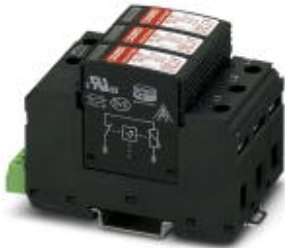
Überspannungsableiter für 4-Leiter-Stromversorgungssysteme (L1, L2, L3, PEN), bestehend aus Basiselement mit FM-Kontakt und Schutzsteckern, zur Montage auf NS 35.
