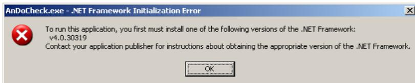
Fehlermeldung bei fehlendem .NET Framework oder falscher Framework-Version.
