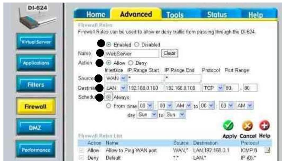
Abbildung oben: Firewall-Konfiguration am Beispiel eines Web-Servers.
