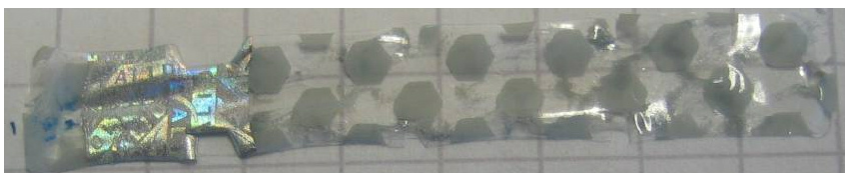
Beschädigtes Siegel mit Schachbrettmuster
