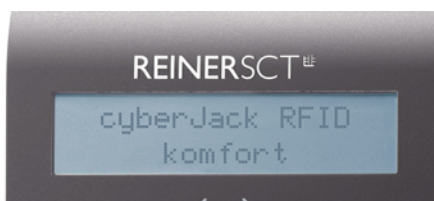
Standardanzeige im Betrieb des Chipkartenlesers
