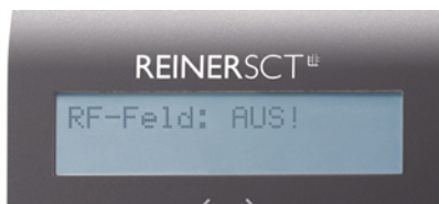
Das RFID-Feld ist jetzt ausgeschaltet
