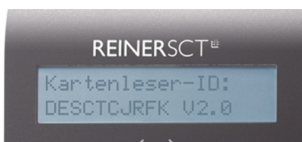
Anzeige der Chipkartenleser-ID (Anzeige erfolgt nur beim Drücken der @-Taste)
