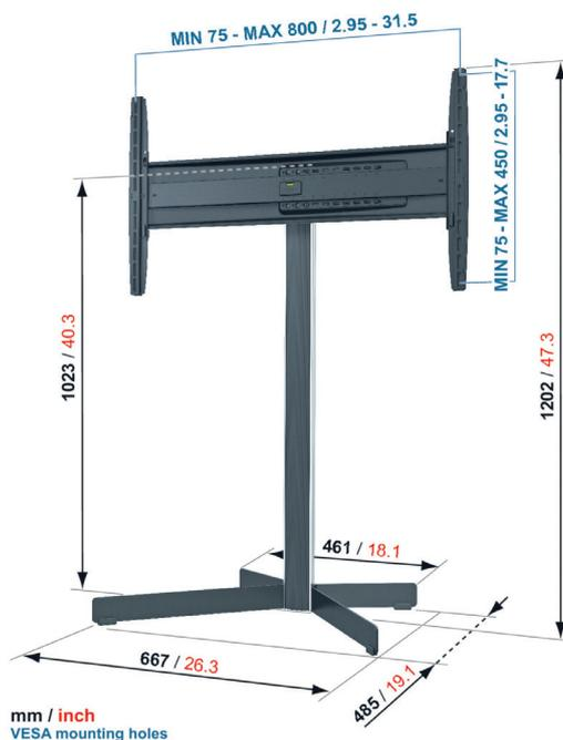
Dieser Standfuß eignet sich für Flachbildfernseher mit einer Diagonale von 32 bis 50 Zoll (81 – 127 cm) und einem Höchstgewicht von 45 kg.
