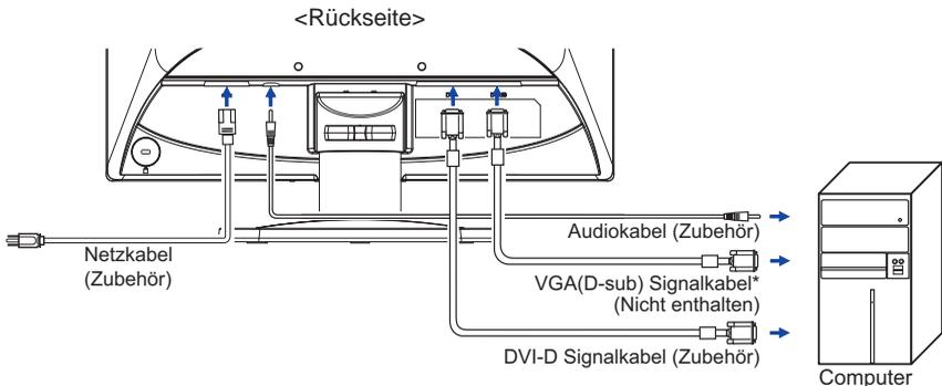
\* Das VGA (D-Sub)-Kabel ist nicht im Lieferumfang enthalten. Für den Betrieb über VGA benötigen Sie ein spezielles VGA (D-Sub-Kabel) für dieses Modell. Bitte kontaktieren Sie das iiyama Support Center in Ihrem Land, wenn Sie den Monitor über den VGA-Eingang anschließen wollen.
