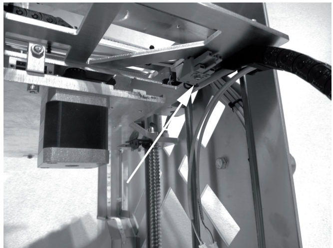
Steckverbinder für die Stromversorgung der Heizplatte mit einer Zylinderkopfschraube M3x16 an der Unterseite des Unterbares montieren.
