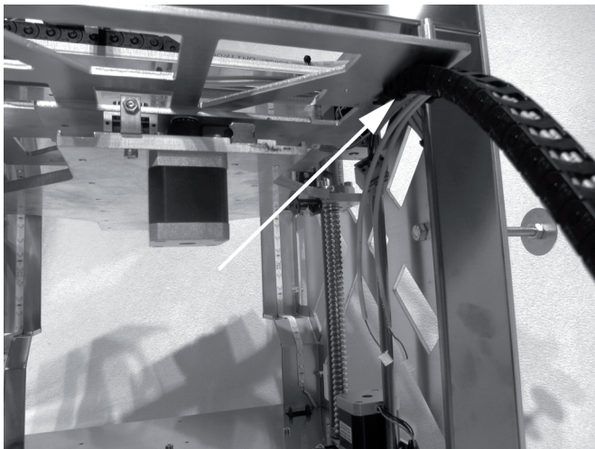
Schleppkette am Endstück des Unterbares einrasten und die Leitungen soweit aus der Schleppkette herausziehen, dass sie sauber verlegt werden können.
